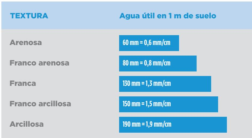
**Figura 4.** *Relación entre la textura y profundidad del suelo y la capacidad de retener agua útil.*
